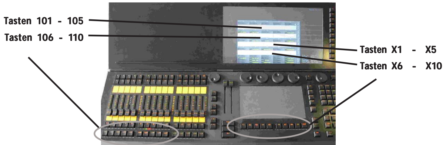
Foto zeigt ultra-light; an der light Konsole sind die Tasten X11 - X20 nicht aktiv
