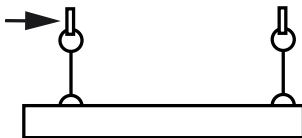
Fig. 16: Kabelaufhängung bei Zweipunktaufhängung
